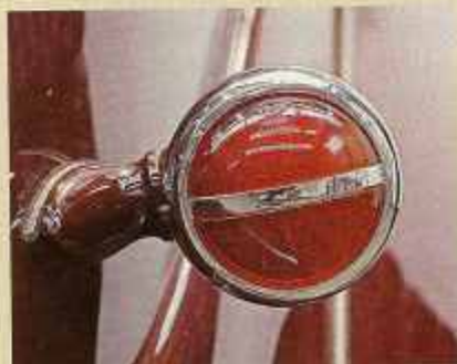
...1,3 Liter aus Vorkriegstagen: Mangels verfügbarer Originalteile griff der Restaurierer auf schmucklosere Standardleuchten zurück
